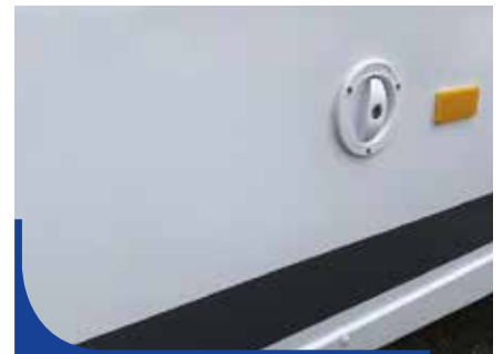
Uzamykatelné venkovní nalévací hrdlo na čistou vodu.
