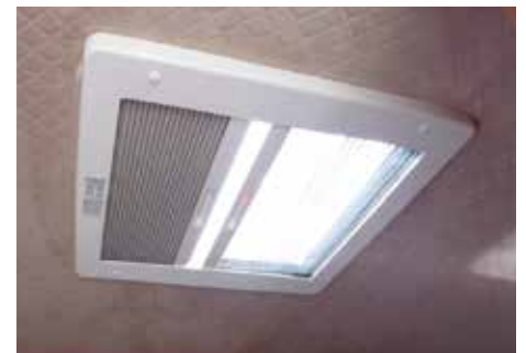
Střešní okno s ventilací, sítkou a zatemněním.
