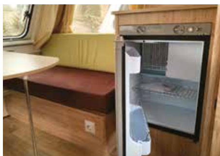
Vestavěná trojkombinační lednice s mrazáčkem (12V/230V/plyn).
