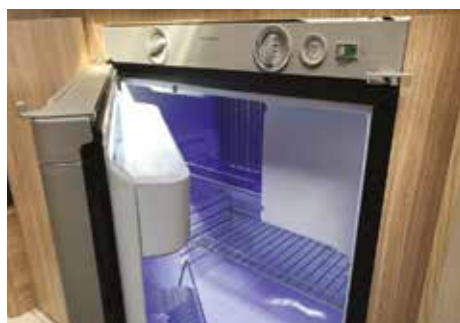
Vestavěná trojkombinační lednice s mrazáčkem (12V/230V/plyn).
